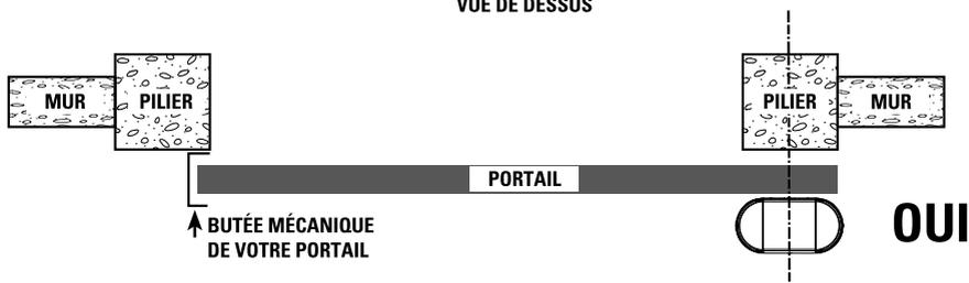
Le bord de la plaque de fixation doit se trouver à 5 cm du bord du portail.
